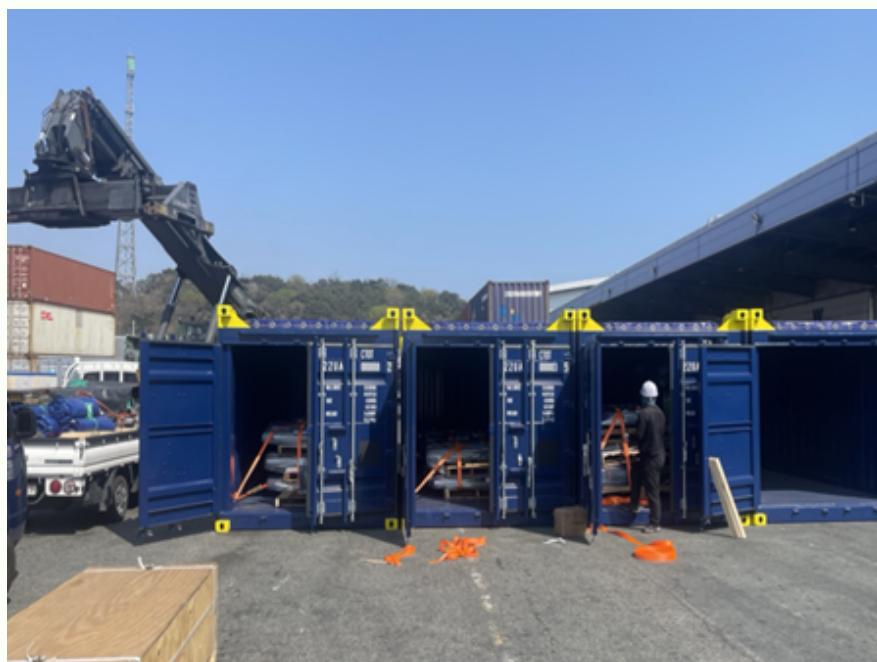
CFS 작업 및 Shoring 작업
